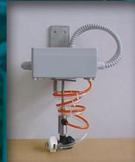
Stazione rotante di erogazione aria-liquido controllata da centralina computerizzata per la distribuzione di soluzioni di Antec Virkon S in presenza di animali (foto: Prochemi)
