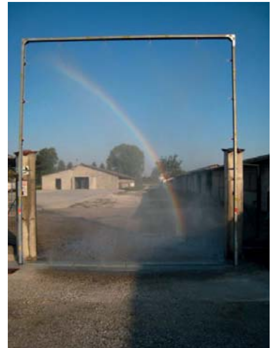
Arco di disinfezione in allevamento avicolo.
